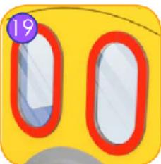
Fenêtres en polycarbonate sécurit de 8mm d'épaisseur.
