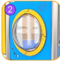
Fenêtre hémisphérique de diamètre 400mm en polycarbonate formé à chaud d'épaisseur 5mm résistant au vandalisme.
